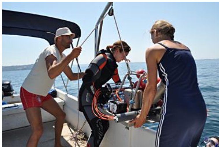
Der mit Kamera, Blitz, Sensoren und Batterien ausgestattete Instrumentendeckel der Kammer (EAGU - Experimental Anoxia Generating Unit) wird über Bord gehievt und dem Taucher überreicht
