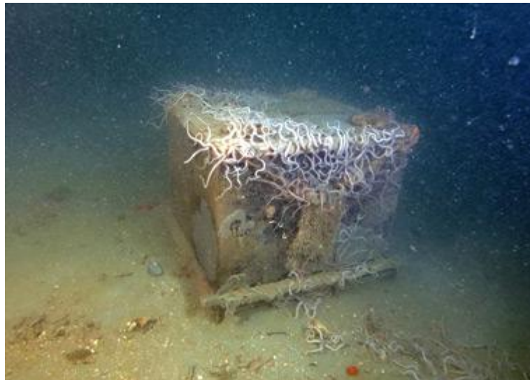
Geschlossene Plexiglaskammer nach einem Jahr unter Wasser, in 23 m Tiefe im Golf von Triest, Nordadria (Photo © T. Makovec)
